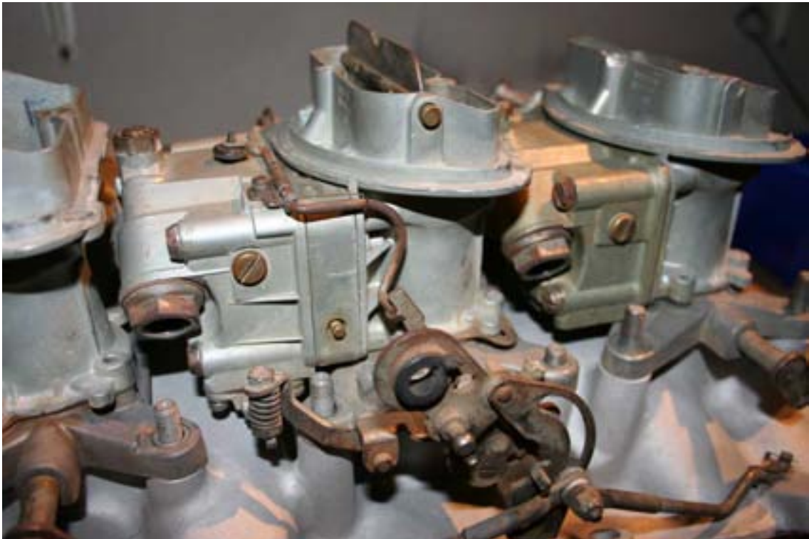
Bilde fra venstre side med bensininntak, aksellerasjonspumpe og gass-spjeld.
