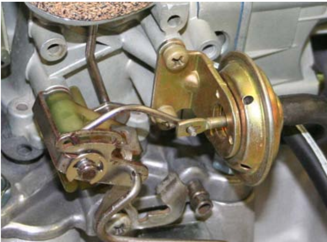
Chokemekanismen. Siden den opprinnelige choke vakuumklokken var korrodert ble denne byttet ut med en ny. Vakuumklokken kontrolleres for eventuelle lekkasjer.
