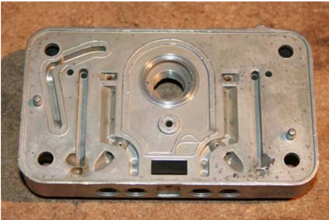
Metering block inneholder tomgangsskruer, power valve og dyser.
