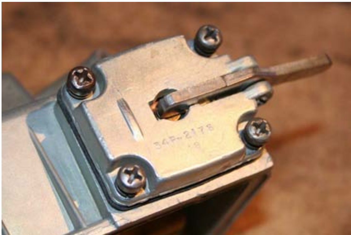
Aksellerasjonspumpen festes med 4 skruer.
