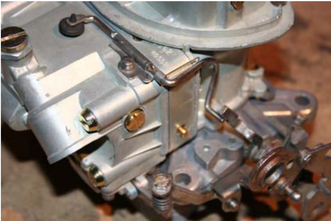
Mekanismen til ventilasjonen av bensinkammeret.
