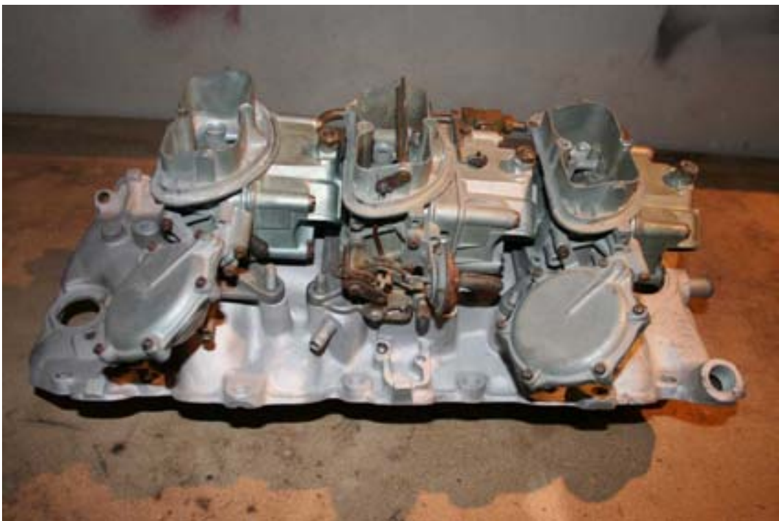
Forgasserne var komplette, men med en god del korrosjon på bl.a. skruer og spjeld.
