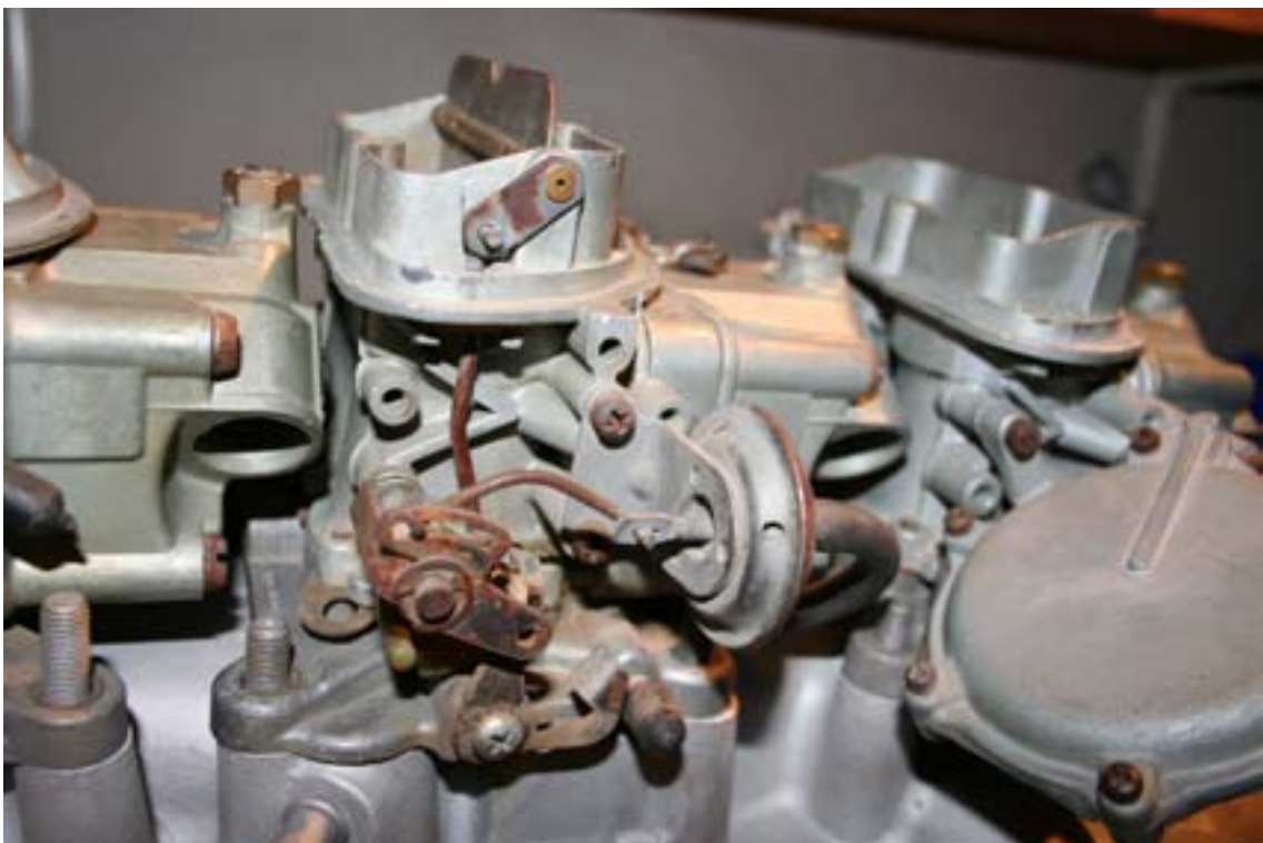
Bilde fra høyre side med chokemekanismen.
